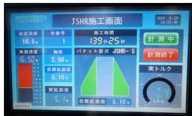
施工管理装置の表示例
